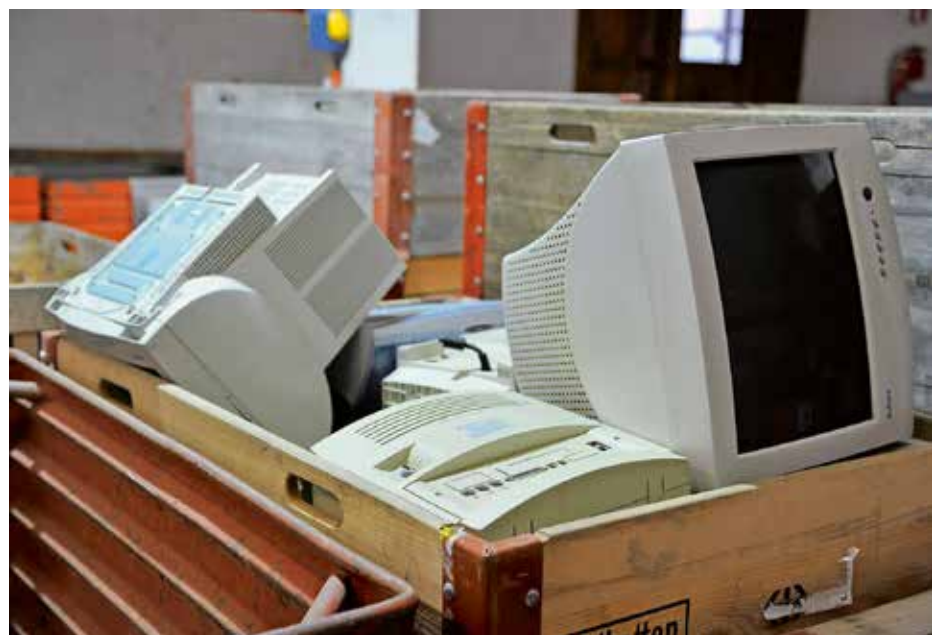
Abb. 19: «Urban Mining»: Aus zirka 72 Tonnen Elektroschrott wird eine Tonne Kupfer gewonnen. Bild R. Kühne
